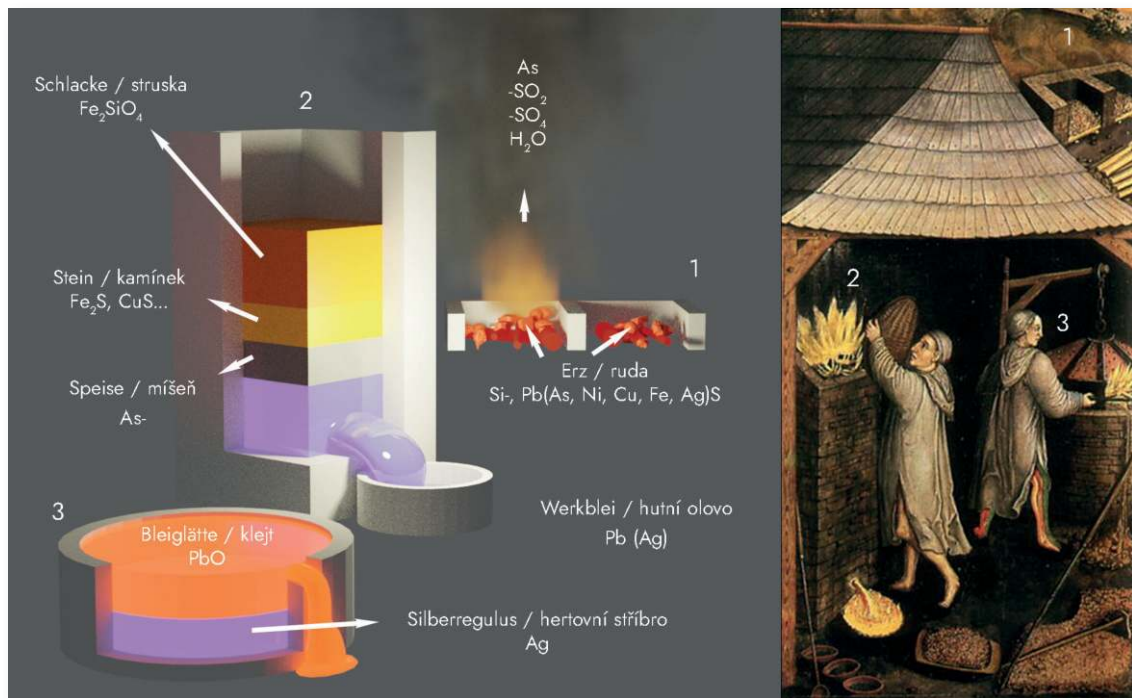
Obr. 70 Proces hutnictví stříbra – schéma a vyobrazení na Annaberském hornickém oltáři. 1 pražení, 2 hutnění, 3 kupelace.
