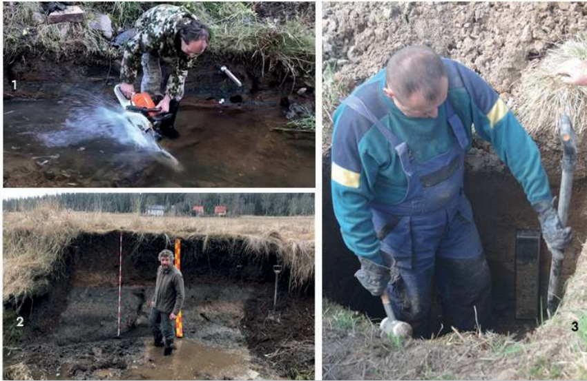
Obr. 87 K metodám používaným při výzkumu v aluviích patří: 1 odběr dřev na dendrochronologii, 2 sedimentologický popis vrstev, 3 odběr vzorků na pylové analýzy a makrozbytkovou analýzu.
