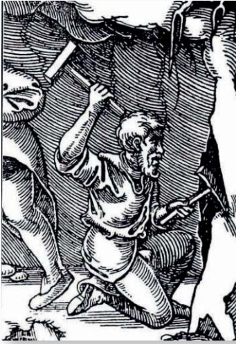
Obr. 40 Práce s želíz- kem a mlátkem.
